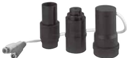
电子目镜采用了最新的图像传感技术，为更多的人认识和研究微观世界，提供了更为便捷的方法。电子目镜可与各种光学显微镜配套使用，只要把显微镜的目镜移出，将本装置插入到位即可使用。电子目镜将其输出信号用视频电缆送到普通电视机的视频接口中，将显微图像放大输出到电视机屏幕、录像机或计算机上，电子目镜也可以通过投影机将显微图像放大到更大的投影屏幕上，供更多的人观看。适用于教学、产品展示、科普宣传、显微手术和显微加工与装配生产。
