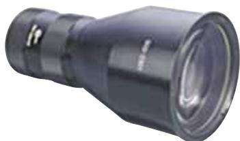
使用 1/2" 的 CCD 检验一个直径为 45mm 的圆形物体。下图为可选择的组合方式之一。该系统的放大倍率为 0.16。镜头总长度为 137mm。CCD 接圈可与系统一起提供。
