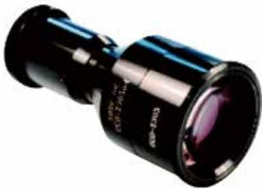
景深是数值孔径的函数。在理论上，一般系统与远心系统景深的理论值相同，但实际上对成像系统或人眼来讲，远心系统可用的景深要大的多。其原因在于：系统虽然离焦但放大倍率不变。离焦时，像变模糊但仍能清晰显示图像的位置及边缘。
