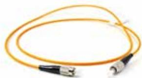
大恒光电提供纤芯直径为 50 μm 和 62.5 μm 的渐变折射率多模光纤跳线。相比于阶跃折射率多模光纤，渐变折射率多模光纤的纤芯到包层折射率逐渐变小，这样可以减少模间色散，提高光纤带宽，增加传输距离，适合通信应用。
